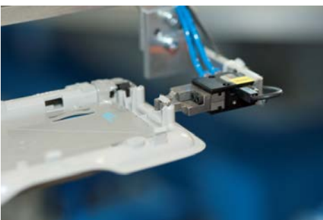
Bild 6: Mit zwei Parallelgreifern des Typs MGP803N führt der Roboter das fertige Bauteil an einer Laserstation vorbei 5203
